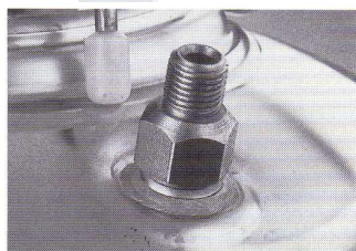
Conexión con reducción de R1/4", fuera del tanque
