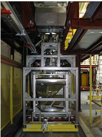
Traslado de contenedores con carrito de dosificación con balanza integrada
